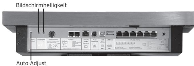
Abb. 9: Tasten für Bildschirmhelligkeit und Auto-Adjust
