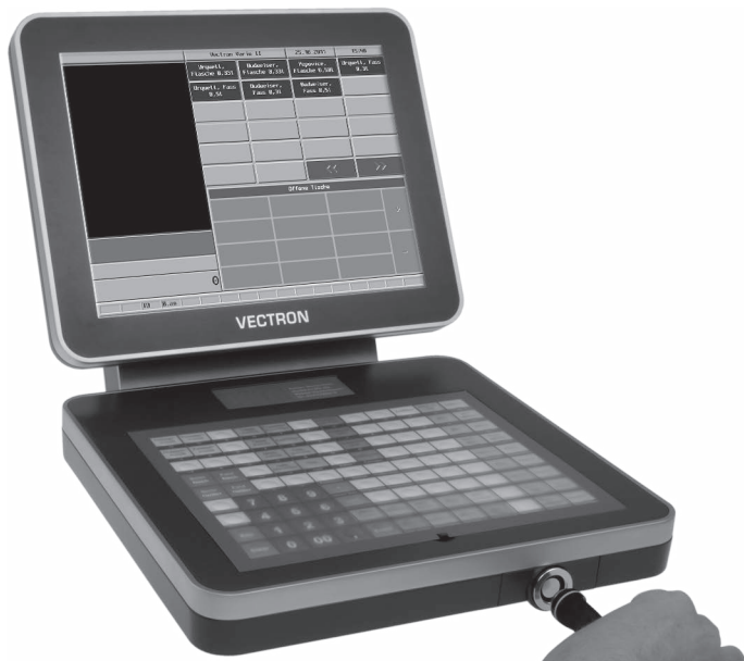
Abb. 21: Schlüssel an das Schloss halten oder vom Schloss abziehen
