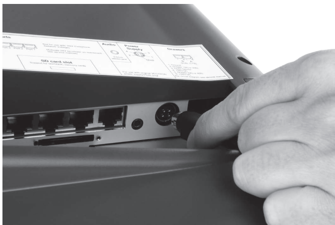
Abb. 12: Stromkabelstecker in Stromanschluss stecken
