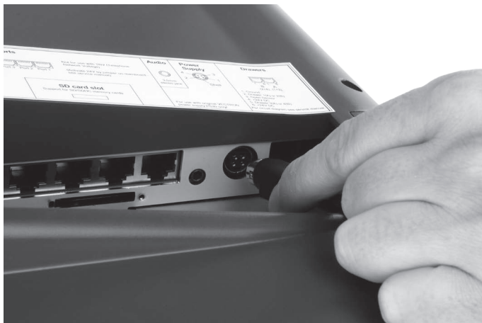
Abb. 24: Stromkabelstecker aus Stromanschluss ziehen
