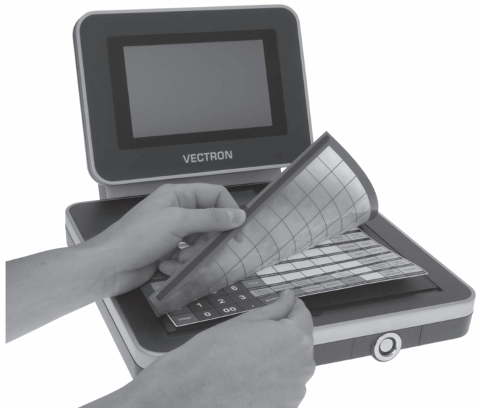
Abb. 14: Tastaturfolie anheben und Einlegeblatt ausrichten
