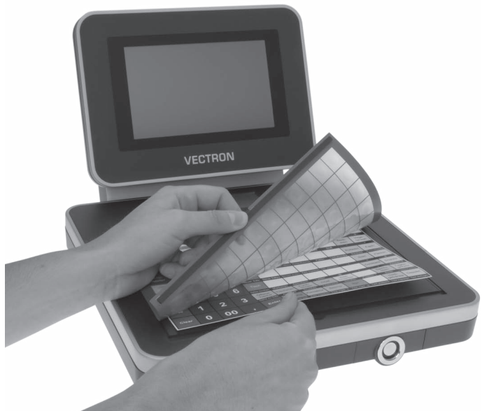
Abb. 26: Tastaturfolie anheben und Einlegeblatt ausrichten
